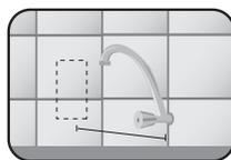
2 - Após, verifique a distância entre a torneira e o local de instalação do purificador (máx. 6m).
