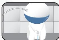
10 - Abra o registro do purificador, após, verifique possíveis vazamentos nas conexões. Em seguida deixe correr 20 litros de água para liberar o pó do carvão\*.
